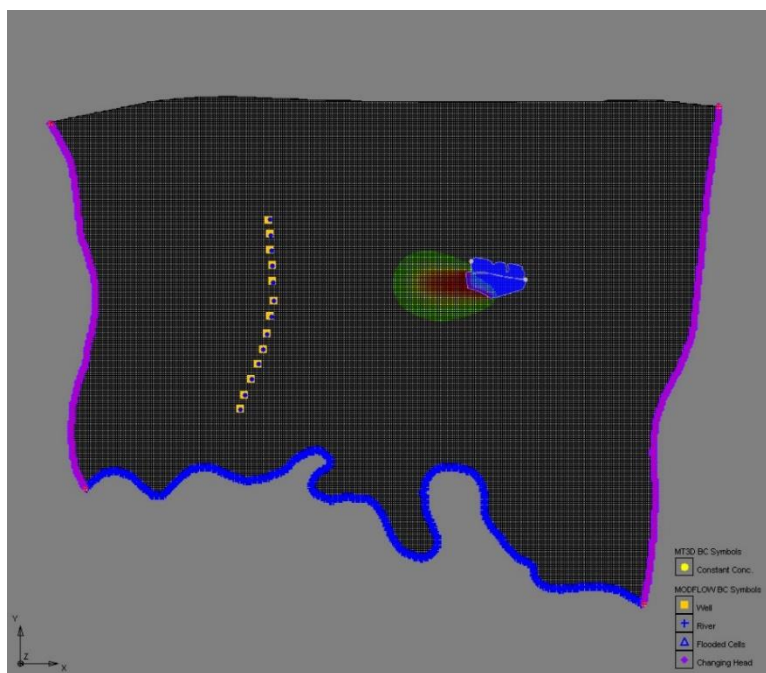
Figura 4.1.1.67 Simulare MT3D – evoluția penei de poluant după 5 ani
