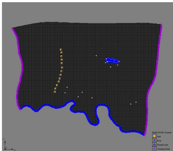
Figura 4.1.1.64 Geometria modelului matematic de curgere a apei subterane
